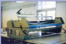
一人で延反機2台を操作できる対向型
